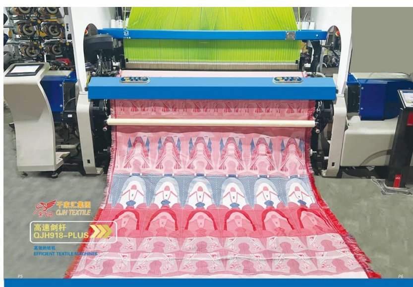
2.51-rasm. QJH918-PLUS rusumidagi havo yordamida arqoq tashlovchi jakkard to‘quv dastgohi
