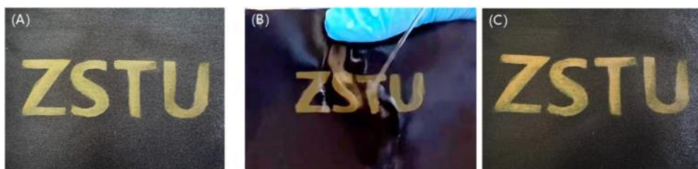
Рисунок 19. Сравнение после испытаний на стойкость к стирке: (А) ткань, (В) ткань во время испытания на стойкость к стирке, (С) ткань после испытания на стойкость к стирке.
